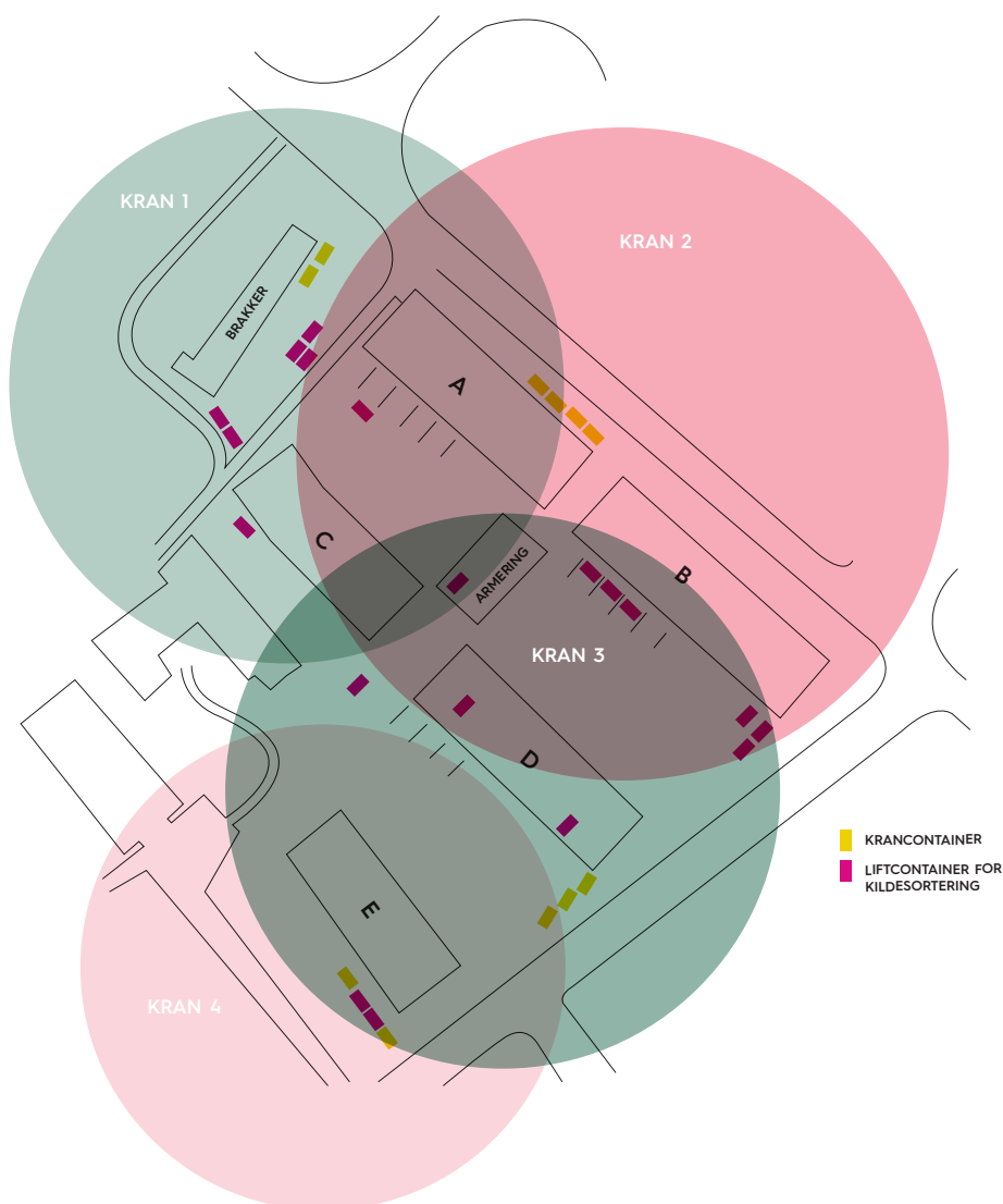
FIGUR 4: EKSEMPEL PÅ RIGGPLAN FOR EN BYGGEPLASS. MILJØSTASJONENE ER Plassert innenfor kranenes arbeidsområde
